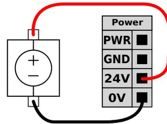
この例で示すデフォルト構成では内部電源が使用されています
