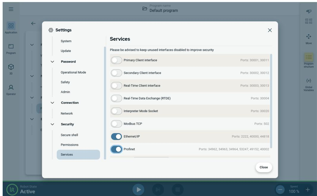
**EtherNet/IP の使用** PolyScope X で EtherNet/IP 機能を見つけます。
