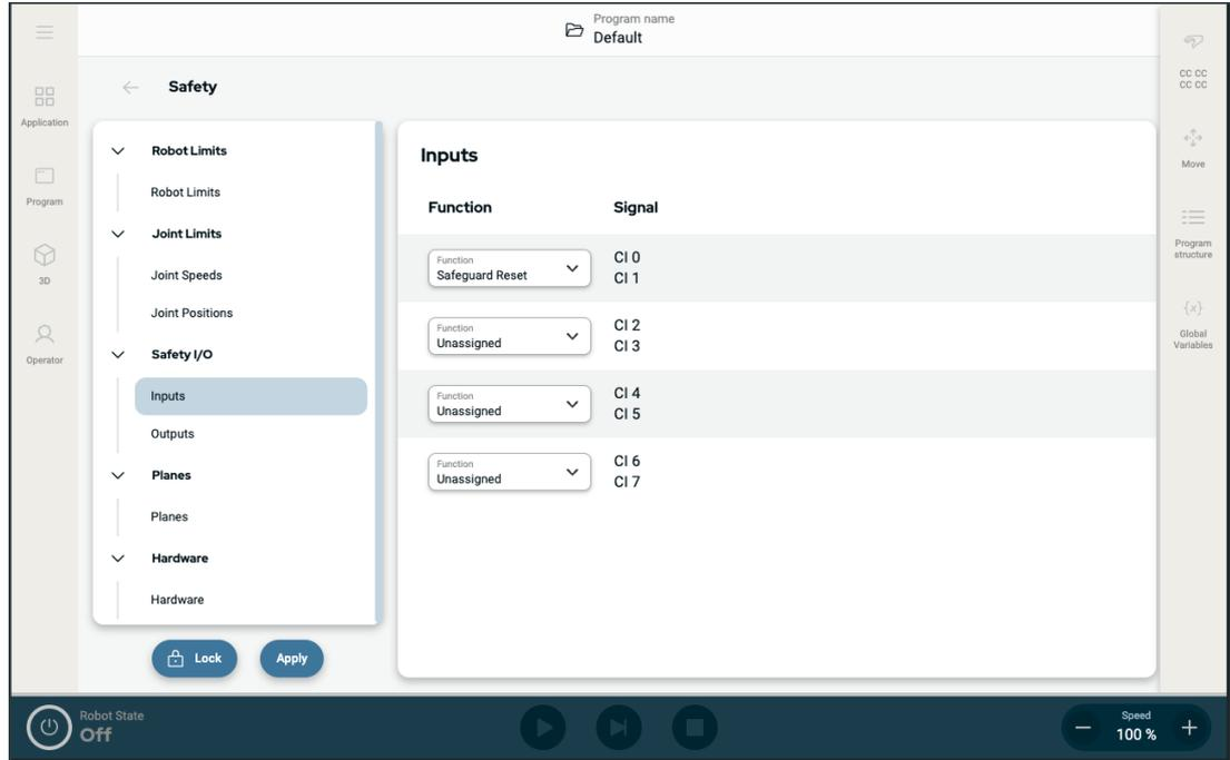
図 1.3: 入力信号を表示する PolyScope X 画面。
