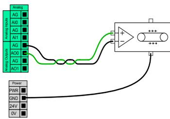
この例ではアナログ速度制御入力でコンベヤベルトを制御する様子が示されています。
