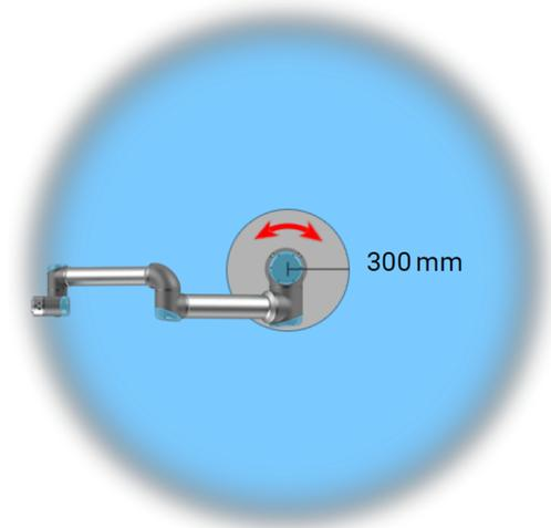
ロボットアームの物理特性により、特定の作業空間領域は挟み込みの危険に関して注意が必要になります。1つの領域(左)は、リスト1ジョイントがロボットのベースから最低 1300 mm の距離にある時の半径方向の運動で定義されます。他の領域(右)は、接線方向に移動している時にロボットのベースから 300 mm 以内になります。
