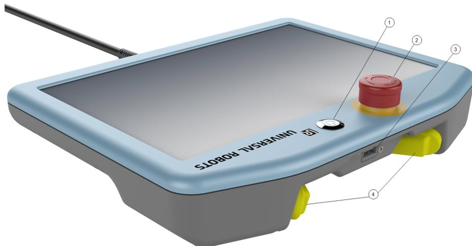
フリードライ フリードライブロボットのマークは、以下の図のように各3PEボタンの下にあります。
