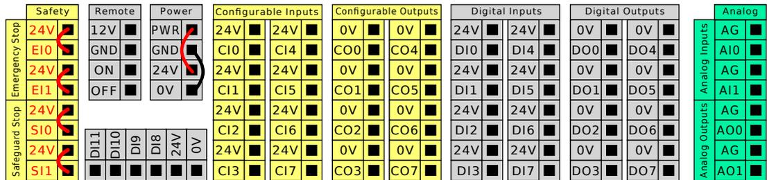
下図に示すように、これらのタイプの入力に対して水平デジタル入力カブロック (DI8-DI11) を AB 相エンコーディングコンベヤトラッキングに使用できます。
