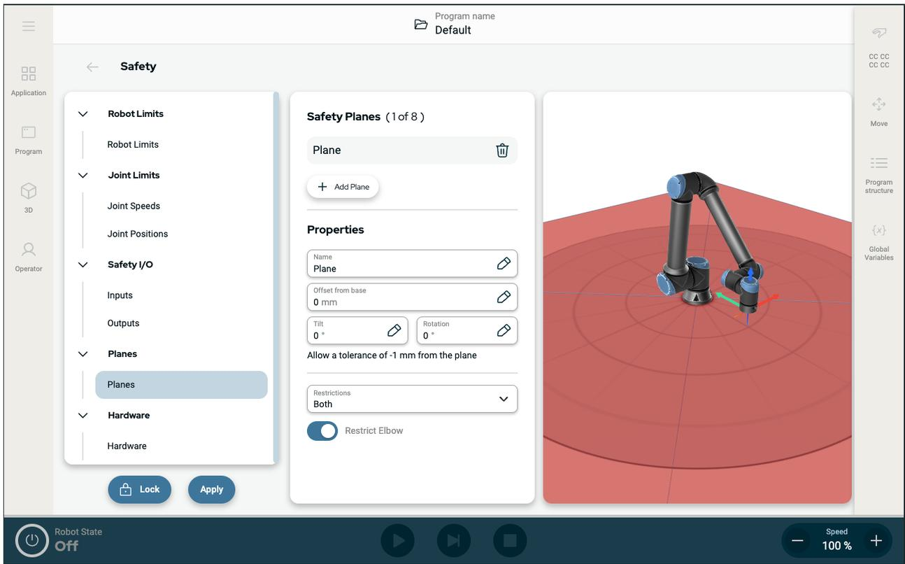
図 1.4: 安全平面を表示する PolyScope X 画面。
