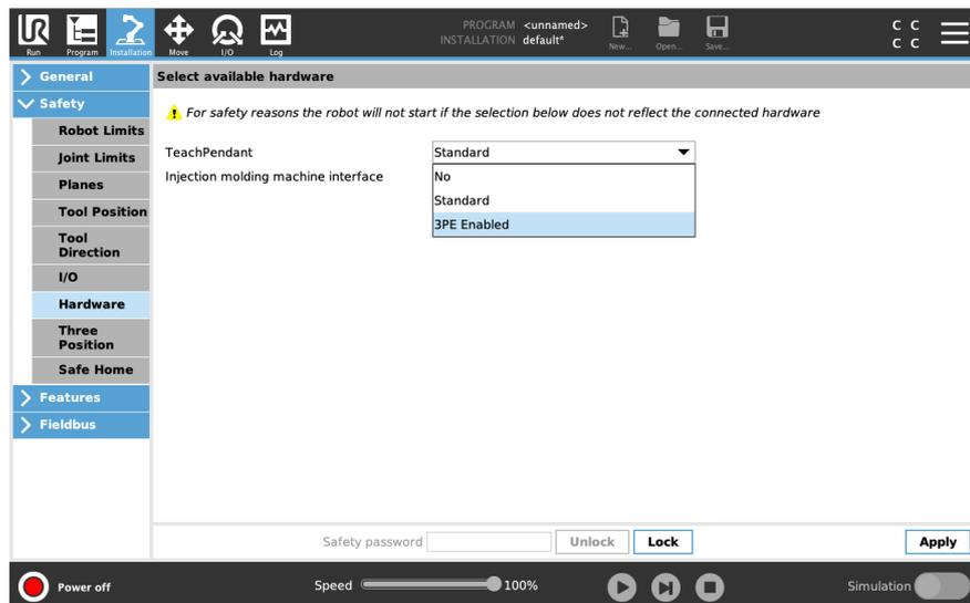
3. [ティーチペンダント] ドロップダウンリストで、[3PE有効] を選択します。
