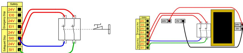
この例では、ドアが開くとロボットが停止する基本的な安全装置であるドアスイッチが示されています。
